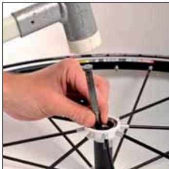
Extraiga los rodamientos mediante el útil de montaje / desmontaje 323 909 01
