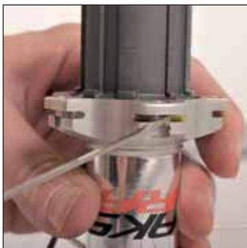
El 2º radio a la derecha del orificio de la válvula es no tractor y va montado en el interior del ala del buje. Introdúzcalo en el alojamiento del buje, y haga lo mismo con un radio de cada 4.
