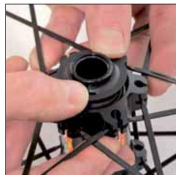
Vuelva a montar el guardapolvos empujándolo paralelamente al eje.
