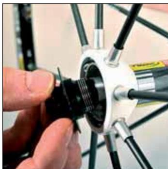
Seleccione el apoyo al cuadro / horquilla que optimice la holgura siguiendo el proceso de ajuste de la holgura de los rodamientos QRM SL.
