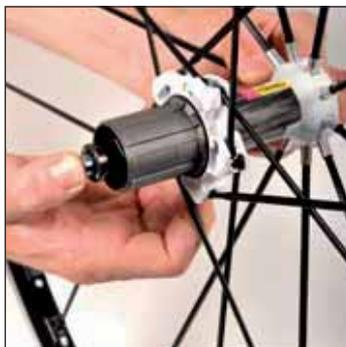
Saque el eje empujando sobre el extremo del eje por el lado del piñón.
