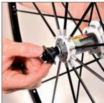
Elija el apoyo al cuadro que optimice el ajuste de la holgura aplicando el proceso de ajuste de la holgura de los rodamientos QRM SL.
