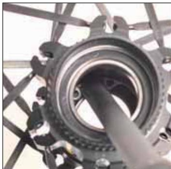
Introduzca un útil de desmontaje por el lado del disco y extraiga el rodamiento del lado opuesto al disco (tenga cuidado de no dañar el circlips que está junto al rodamiento).
