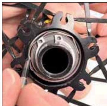
Mantenga la presión sobre el eje por el lado opuesto al disco y al mismo tiempo, mediante el destornillador, presione sobre la horquilla en 3 puntos (los dos extremos y el centro) para hacer deslizar esta hacia el interior.
