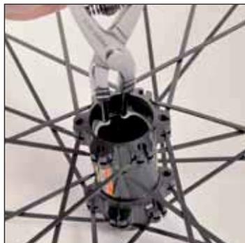
Desde el lado opuesto al disco, mediante el alicate para circlips interiores, saque el primer circlips interior (el del lado opuesto al disco) y luego el segundo circlips interior (por el lado del disco).
