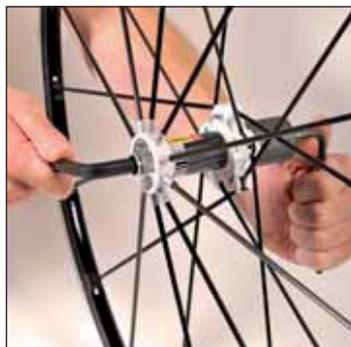
Introduzca la llave allen de 5 mm en el eje por el lado del piñón y la llave allen de 10 mm por el lado opuesto. Desenrosque el eje.
