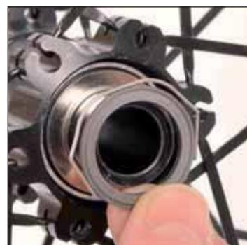
Monte el conjunto horquilla / arandela por el lado opuesto al disco presentando la parte cónica hacia el interior, y la ranurada hacia el exterior.
