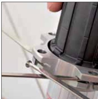
El 4º radio a la derecha del orificio de la válvula es tractor, y va montado al exterior: insertelo en la ranura del buje, y haga lo mismo con todos los radios restantes.
