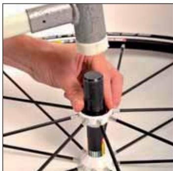
Vuelva a montar los nuevos rodamientos mediante el útil de montaje / desmontaje de los rodamientos 323 909 01
