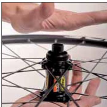
Retire la arandela cónica, la horquilla y la arandela plana golpeando suavemente sobre el eje por el lado del disco **(¡Tenga cuidado de no perder estos 3 elementos!)**.
