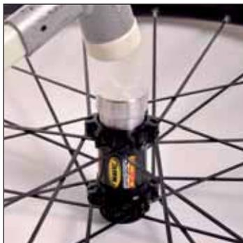
Mediante el útil de montaje 996 887 01, monte el nuevo rodamiento del lado opuesto al disco.
