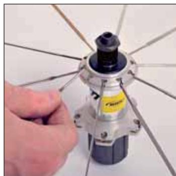
Con el orificio de la válvula junto a usted, pase un radio, con la cabeza por delante, por el segundo agujero a la derecha del orificio de la válvula, y continúe haciendo lo mismo en uno de cada dos agujeros.
