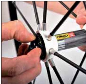
Retire con la mano el apoyo a la horquilla (insertado en el eje) por el lado de la pegatina del buje.
