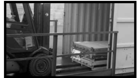
Fig.8 - Para tomar el palet por el lado corto (ej. al descargar containers) utilizar indefectiblemente horquillas de al menos 2,5 m para asegurar un agarre perfecto y la integridad del material levantado.
