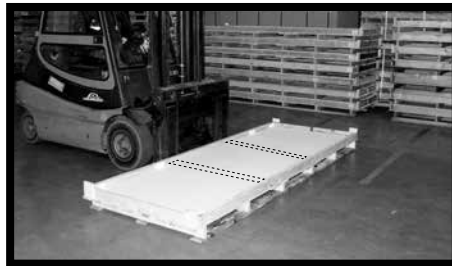
Fig.7 - Para tomar el palet por el lado largo, poner las horquillas distanciadas al menos 1 m entre sí, perpendiculares al lado largo del palet, y en el centro de éste. Las horquillas deben sujetar el palet en toda su profundidad.
