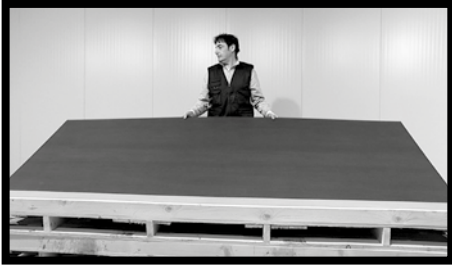
Fig.1 - Las placas de 300x100 cm de cualquier tipo de KERLITE pueden ser levantadas por una persona. Levantar la placa con las manos abiertas; hacerlo lentamente por el lado más largo, eliminando de esta manera el efecto ventosa debido a la adherencia con la placa subyacente y permitiendo un buen agarre.
