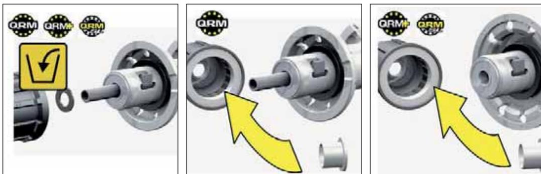
Los antiguos núcleos de rueda libre M10 M40592 y ED11 M40591 con rodamiento de 8 mm de diámetro interior y tapa protectora del rodamiento de color negro no son compatibles con las nuevas ruedas comercializadas a partir de la gama 2013.
