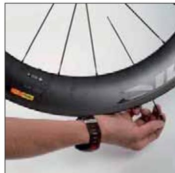
Con el orificio de la válvula junto a usted, introduzca un radio en el 3º orificio a la derecha del de la válvula.
