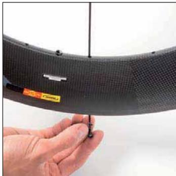
Con el orificio de la válvula junto a usted, introduzca un radio en el primer orificio a la derecha del de la válvula, y siga introduciendo el resto de los radios en uno de cada 2 agujeros.
