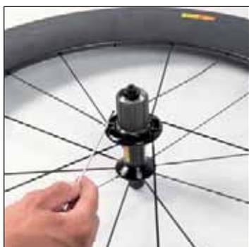
Este radio es tractor, introduzca su cabeza en el alojamiento correspondiente del buje, manteniéndolo siempre por encima de los radios no tractores.
