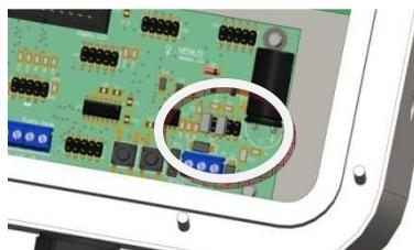
Para que el equipo permanezca siempre encendido deberá montar un JUMPER en la posición 3 del conector H1 de la placa principal del indicador.
