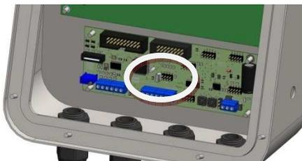
Desenergice y luego abra el equipo. Ubique el Conector H6 sobre la placa principal y coloque allí un jumper en la posición 1. Vuelva a ensamblar el indicador.
