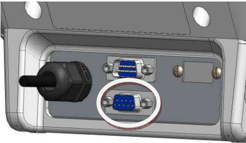
La conexión de la celda de carga se realiza utilizando un conector tipo DB9 hembra.
