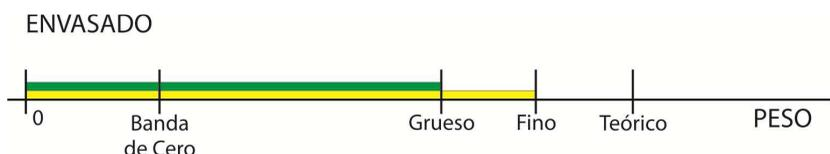
Luego el indicador activará la salida de **DESCARGA** y esperará a que el peso sea menor a la **banda de cero** programada para activar la salida **LISTO** indicando que puede iniciar un nuevo ciclo.
