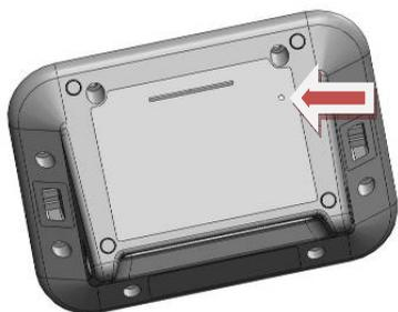
Orificio para acceder al pulsador de acceso a calibración.
