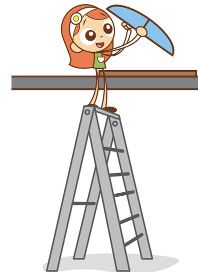
**Si están rotas** reemplace de manera inmediata con otras de igual color, tamaño y espesor sellando correctamente las juntas con silicón.
