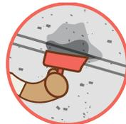
Si hay faltantes en la junta reponga el mortero, preferentemente con cal y arena o una mezcla de cemento y arena.
