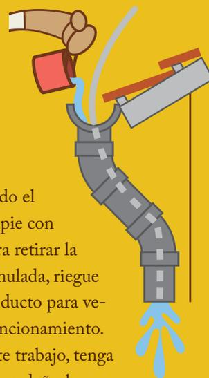
**De existir fugas en elementos de tol, corrija las soldas y si es en P.V.C., selle las uniones con cemento plástico.**
