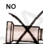
Apoyo en la campana
