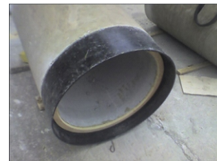
Fig. 3.5 Tubería de concreto para hincar
