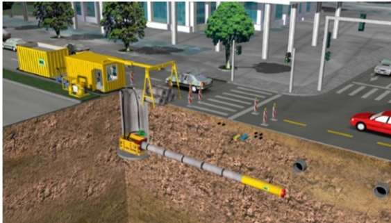
Fig. 3.6 Sistema de hincado
