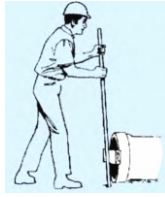
Fig. 3.33 Instalación manual de tuberías de diámetros menores
