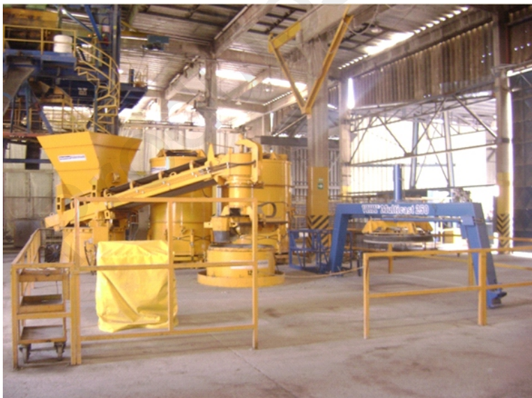
Máquina de vibrocompactado tipo Multicast 250.
