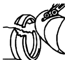
Fig. 3.32 Mala práctica de instalación de tuberías
