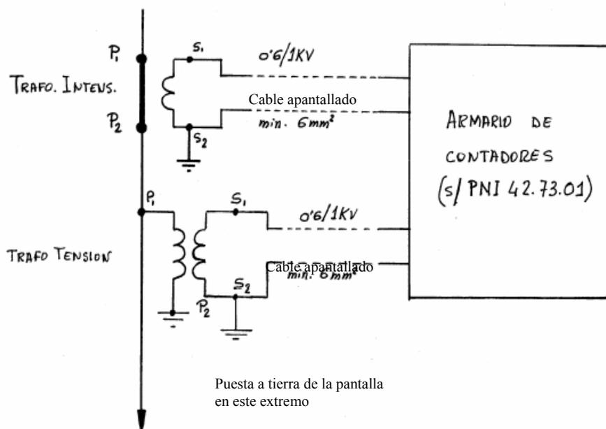
La instalación de los transformadores de medida se hará de forma que sean fácilmente accesibles para su verificación o eventual sustitución.
