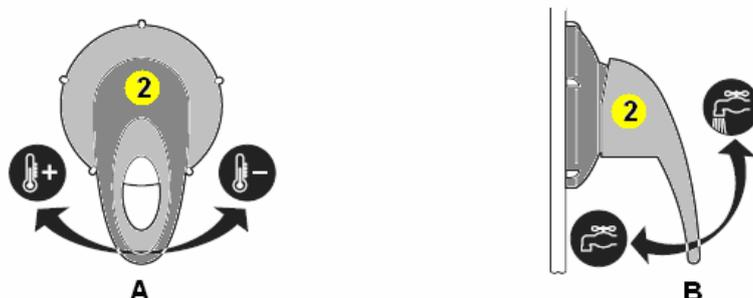
Fig.6 Regulación del caudal y temperatura
