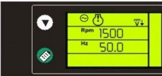
Bajo voltaje de batería (pre alarma, el display permanece estable)
