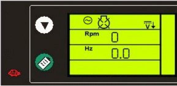
El indicador de bajo voltaje de batería continúa presente, y el icono de alarma común ha cambiado al símbolo de alarma crítica (este se mostrará parpadeando)
