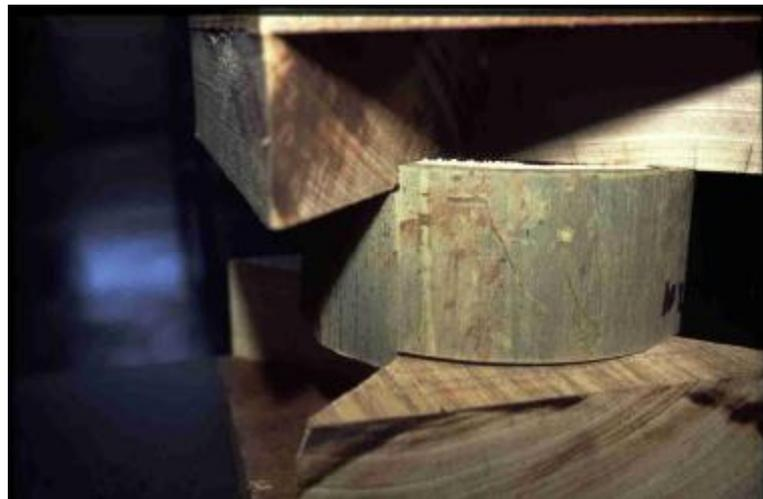
**Figura 12** Dispositivo guía de apoyo y carga para el ensayo de corte.
