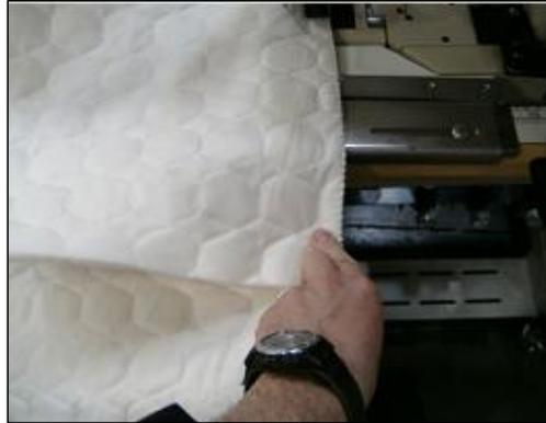
8) Use el lado derecho del pedal y cosa a través hasta llegar a la línea de costura existente. Pise el lado izquierdo del pedal y levante el prénsatelas y el rodillo y remueva el material que está debajo de ellos.
