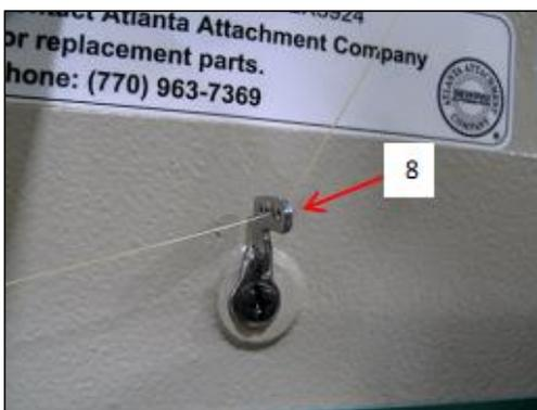
9) Enhebre a través del segundo ojete a un lado del Cabezal de costura
