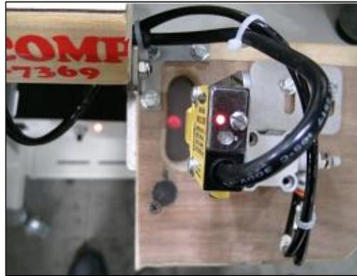
Chequee la cinta reflectante del ojo sensor de la Rueda Manual. Límpiela con un paño suave y seco o reemplácela si es necesario. Si la cinta es reemplazada puede ser necesario ajustar la sensibilidad del ojo sensor, siguiendo las instrucciones de la Rueda Manual y el Ojo Sensor del Panel en la sección de Ajustes
