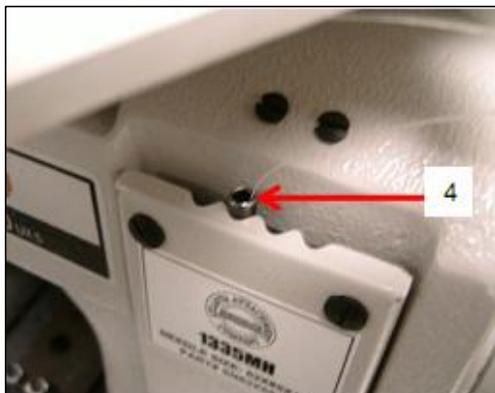
5) Enhebre a través del ojete superior del montaje de tensión de hilo del Engarzador.
