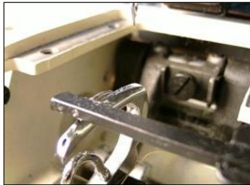
Ambos ajustes izquierda/derecha y el ajuste de la altura de la punta del extendedor se consiguen aflojando los dos tornillos de presión (15) en el soporte del extendedor (16) y moviendo el extendedor de izquierda a derecha, hacia arriba o hacia abajo como se necesite.
