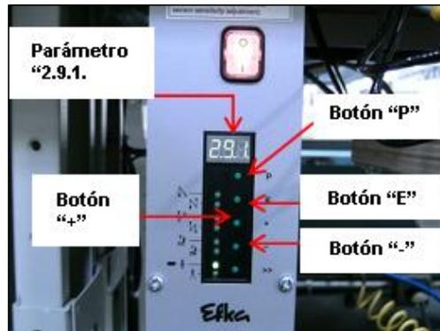
11) La pantalla mostrará ahora el ajuste a la máxima RPM. La pantalla solo muestra tres números, la verdadera RPM en este ejemplo es de 3200 RPM . Ud. necesitará coser por lo menos una puntada para bloquear los cambios en los parámetros y completar el proceso.
