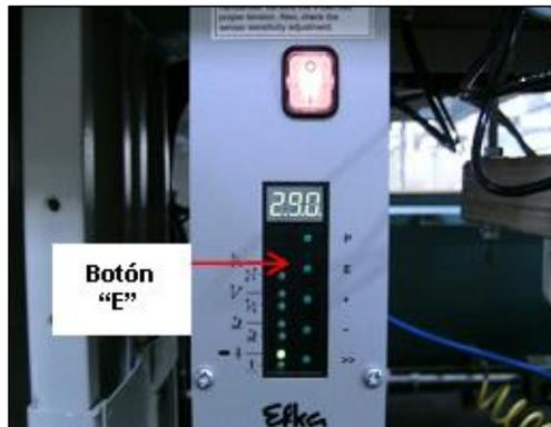
9) La pantalla cambiará de “2.9.0.” a “05” (su pantalla puede no mostrar lo mismo, depende del tipo de cabezal de costura que se está usando, referirse a la hoja de programación del manual de la máquina que esté usando) este es el ajuste del parámetro “2.9.0.” todos los números mostrados en la pantalla sin “.” Son los valores de los parámetros. Para cambiar este número use los botones “+” o “-“. Luego presione el botón “E” una vez.
