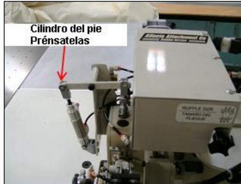
La tensión del panel trabaja pinchando el panel entre él y la placa superior. Esto es ajustado basado en el tipo de panel que está siendo cosido, 15 psi es normal. Si el panel se frunce entonces debe haber muy poca tensión en él; si el borde se frunce entonces debe haber mucha tensión en él.
