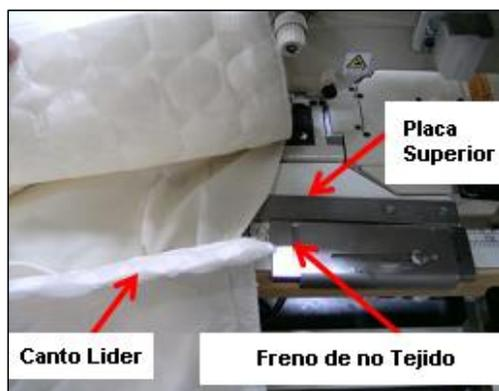
6) Coloque el canto que sigue del material del borde encima del canto líder y cósalo hacia adelante hasta quedar cerca del punto central. Pise el lado izquierdo del pedal y levante el prénsatelas y el rodillo y hale el material fuera de ellos.
