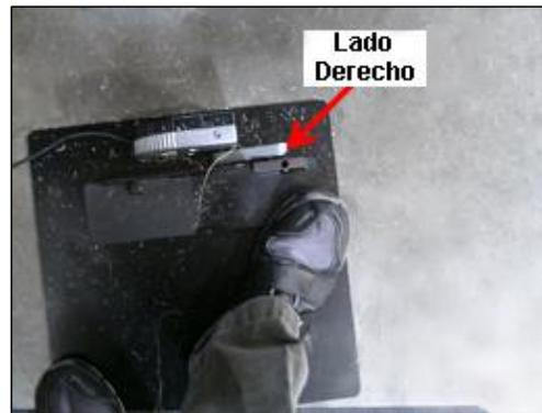
El motor de paso moverá la placa hacia el sensor de salida y parará. Debe haber una L.E.D roja que se enciende en el sensor cuando este lee la placa. Si no lo hace es porque la placa está muy alejada del sensor o el sensor está desconectado o dañado.
