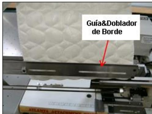
12) El lado derecho de la guía/doblador del Borde tiene guías fijas para el canto derecho del Borde. El lado izquierdo tiene guías movibles. Hay tornillos mariposa en la parte de atrás de la guía/doblador del Borde. Afloje los tornillos y deslice las guías de izquierda a derecha hasta que ellas toquen el lado izquierdo del material del Borde.
