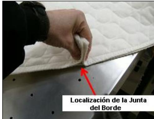
8) Coloque el borde debajo del prénsatelas, pisando en el lado izquierdo del pedal. Alínie la locación o marque para la junta de costura con la aguja. Use el lado derecho del pedal para coser y cerrar la junta. Ud. puede insertar aquí una etiqueta legal cuando se lleva a cabo esta operación.
