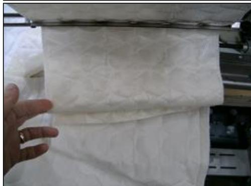
4) Corte el material de borde y gire el montaje del Plegador hacia afuera.
