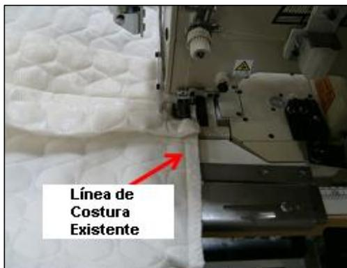
11) Ud. debe tener una cubierta completa cuando cierre la junta de costura.
