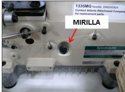
Para añadir aceite gire hacia afuera el ensamble del Plegador para tener acceso al tapón de caucho que está en el agujero del aceite. Remueva el tapón de caucho y añada aceite hasta que el correcto nivel sea alcanzado. Coloque nuevamente el tapón después de rellenar.
