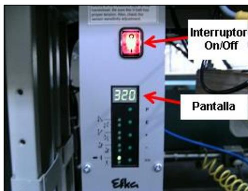
3) Chequee para asegurarse de que la Luz de Encendido localizada en la caja del motor de paso está encendida. Si estas luces no están encendidas entonces apague la corriente en el interruptor principal y notifique al mecánico de la planta.
