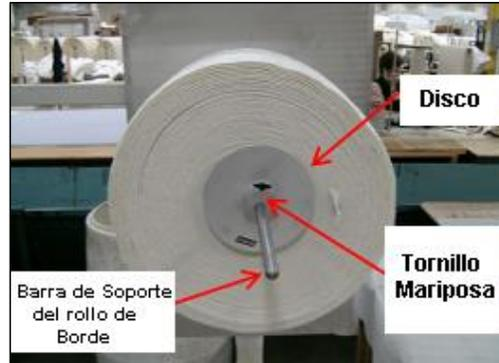
5) Coloque el material en las barras de guía, encima de la primera barra y debajo de la segunda. Mueva la guía de canto lo suficiente para tocar el canto del material. Afloje la manivela del trinquete y corra la guía de canto hacia adentro o hacia afuera como se necesite.
