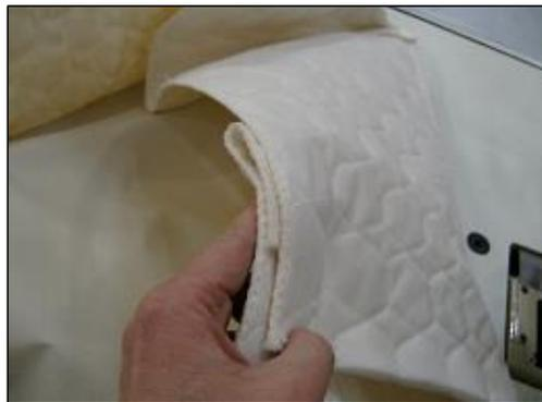
10) Use el lado izquierdo del pedal y levante el prénsatelas y el rodillo y coloque el material debajo de ellos como se muestra.
