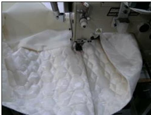
11) Trate de mantener la misma cantidad de dobléz para el canto líder o la junta de costura no quedará recta. Use el lado derecho del pedal y cosa hacia abajo hasta el final del canto del material. Ud. puede insertar una etiqueta legal sí se necesita. Ud. puede producir una cadeneta de remate en esta máquina, pero necesita estar debajo del rodillo y a menor RPM.
