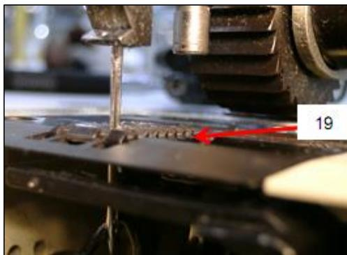
Para ajustar la altura de los dientes de arrastre, , remueva la plancha de agujas y luego afloje el tornillo (20).
