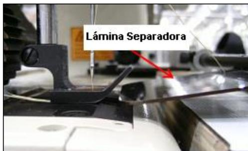
Para ajustar la distancia del canto frontal de la lámina, afloje los dos tornillos de cabeza redonda (sombbrero) localizados en el lado inferior de la barra de soporte de la lámina separadora. Deslice la cuchilla hacia adentro y hacia afuera como se necesite y apriete los dos tornillos.
