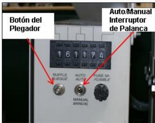
Después de que el botón manual es presionado la cuchilla del plegador se moverá a la posición baja, encima de la lámina separadora.
