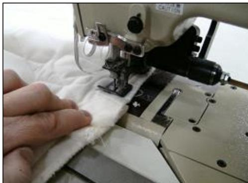
7) Coloque el material extendido, tome los dos cantos finales y póngalos juntos, tratando de encontrar donde se encuentran con el panel; aquí es donde Ud. coserá para cerrar la junta de costura. Ud. puede usar un marcador y marcar donde la junta va a quedar para una mejor alineación de la costura cuando se coloca bajo el prénsatelas para coser.
