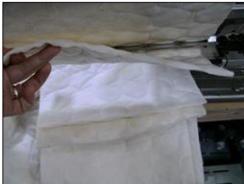
5) Hale el panel de entre el freno de no tejido y la placa superior y póngalo encima de la placa superior. Doble el canto líder del material en dirección suya.
