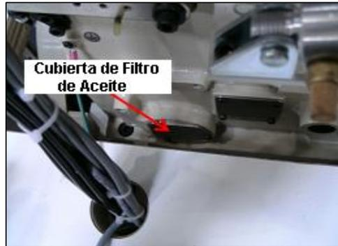
Llene el recipiente de aceite girando hacia afuera el ensamble del plegador y removiendo el tapón de caucho. Coloque nuevamente el tapón después del llenado.
