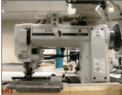
1) Hale el hilo a través del ojete localizado en la montura de ensamble del Plegador. En la parte superior derecho del Cabezal de Costura.
