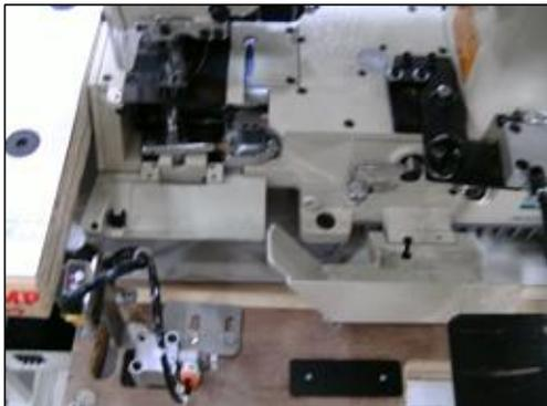
8) Enhebre a través del primer ojete después de tensionar el hilo.
