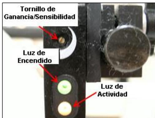
Ajuste el ojo sensor de tal forma que una curva de material de borde sea mantenida mientras se está cosiendo el borde al panel.
