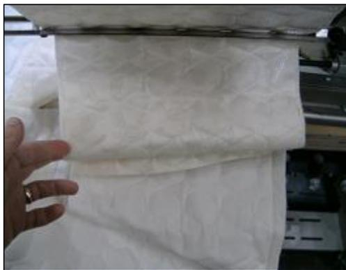
4) Corte el material del borde y gire el montaje del Plegador fuera del camino.
