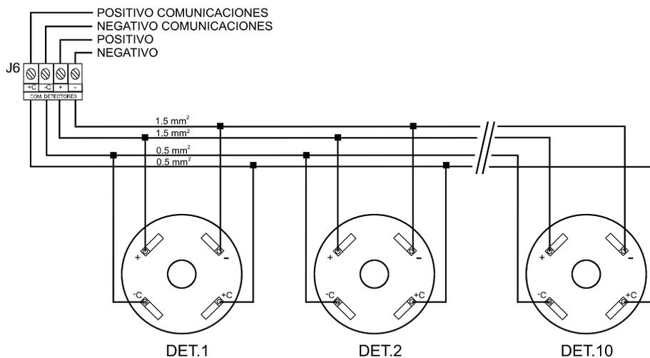
Verifique la correcta conexión de los cables en las bases de los detectores, respetando el código de colores de los cables. **Una conexión errónea puede causar daños en la Central y los detectores.**
