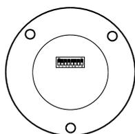
Antes de conectar los detectores en su zócalo es necesario codificarlos. Esta codificación se realiza en binario mediante el dilswitch situado en la base del detector, asignando un número del 1 al 10 a cada uno de ellos.
