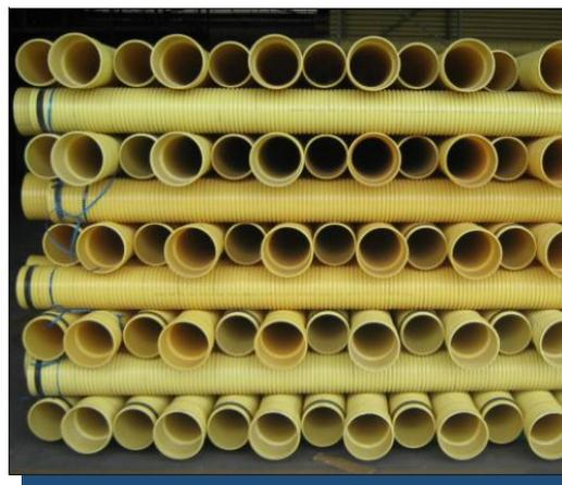
Se recomienda realizar el almacenamiento de cama en el sitio donde se realiza la obra, intercalando campana con espigo en cada plancha. También se puede almacenar la tubería en campo con soportes laterales que cubran la extensión del tubo y alternando campana con espigo, la altura máxima permitida para el almacenamiento de la tubería corrugada es de 1.20m.
