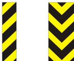
*Delineadores de corona (hitos de arista)*: elemento vertical tipo poste, dotado de uno o varios elementos reflectivos, que se colocan adyacentes a la cuneta o berma de la vía. Tienen por objeto delimitar los bordes de las vías durante las horas de oscuridad o de condiciones atmosféricas adversas y pueden también ser empleados para registrar los hectómetros de la carretera.
