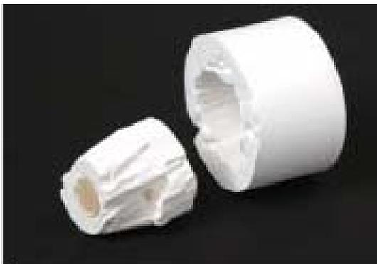
Arenar alrededor de los patrones inyectados con perlas de vidrio (4bar, 50 $\mu$ m), después limpiar los objetos completamente con mucho cuidado (2bar, 50 $\mu$ m).
