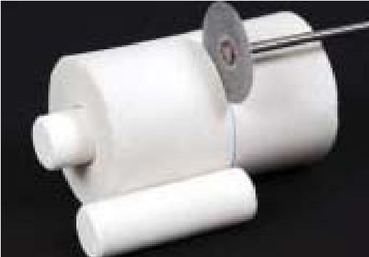
Después del enfriamiento, por favor marcar la longitud del émbolo en el cilindro de revestimiento y cortar a lo largo de la marca, mediante un corte de disco (disco de diamante sinterizado).
