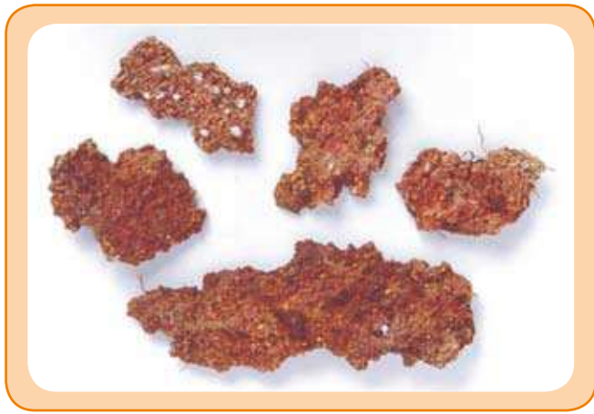
Figura 1. Costras formadas por el óxido de magnesio de baja calidad.
