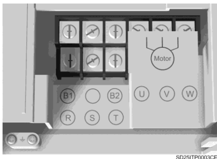
Figura 3.8 Detalle terminales de potencia. Talla 4
