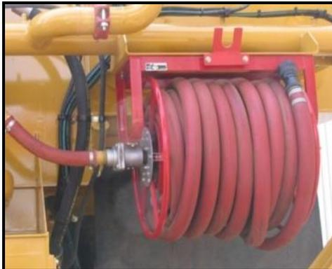
Es un conjunto de carrete ubicado en el extremo trasero inferior del tanque de agua y equipado con una manguera de goma reforzada de 1" o 1,5" de diámetro y una boquilla extintora de incendios. Para poder funcionar, el conjunto de carrete para manguera debe recibir agua presurizada del colector presurizado situado en la parte posterior del tanque.
