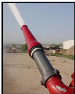
Es un potenciador del rendimiento montado entre la salida del sistema a lanza agua y la boquilla con cavidad recta seleccionada. La trayectoria del formador de chorro es un canal tipo panal de abeja diseñado
