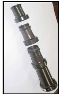
Es una boquilla cónica segmentada que dirige el flujo de agua. La abertura de la boquilla se regula retirando los segmentos para lograr la abertura más eficiente para una determinada presión operativa de la bomba de agua. Los diámetros de los segmentos de
