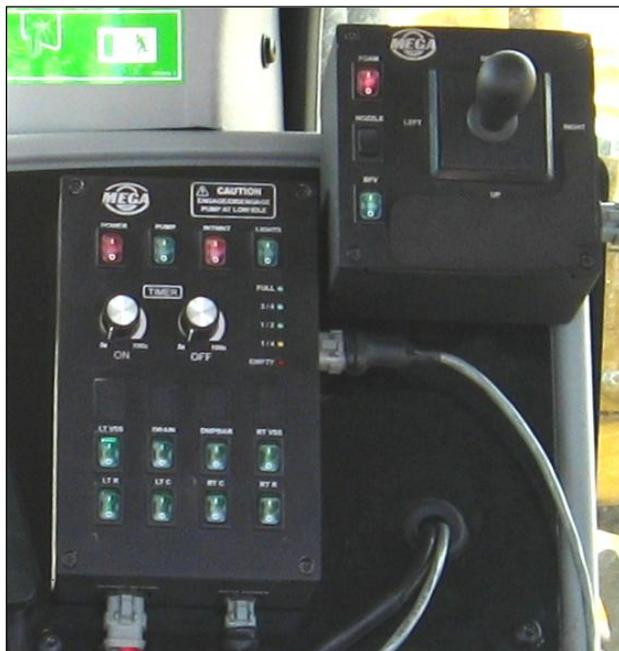
Caja de control principal multi-función con una caja adicional de Joystick montada en la cabina del vehículo. Estas dos cajas controlan todas las funciones del tanque de agua. La caja de control principal opera el sistema eléctrico, bomba de agua, aspersores, regadío
