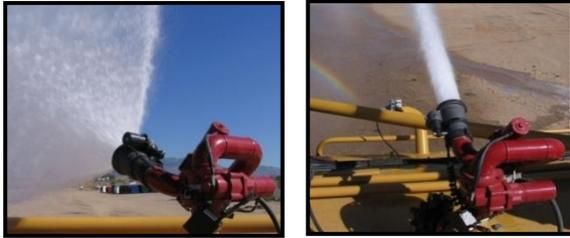
Es una boquilla con cavidad recta modificada que brinda al operador la posibilidad de ajustar de manera remota desde el control de la cabina los patrones de chorro de agua seleccionados entre abanico plano y chorro. Un accionador eléctrico mueve el cilindro interno o externo de la boquilla para suministrar el patrón de abanico o chorro. La dirección del patrón de abanico plano se puede cambiar de horizontal a vertical modificando la orientación de la boquilla en el sistema lanza agua.
