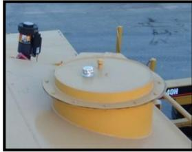
Es un tanque de acero inoxidable montado en la parte superior delantera del tanque de agua. El tanque de almacenamiento temporal posee un tubo
