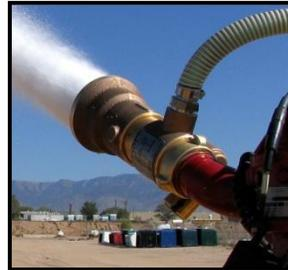
Es una boquilla (niebla/chorro) de ajuste manual o remoto conectada a la vía de agua del sistema lanza agua. La carcasa interna de la boquilla utiliza el agua a alta
