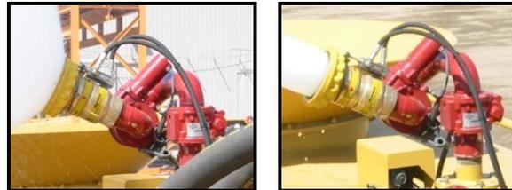
Es una boquilla con cavidad recta modificada que brinda al operador la posibilidad de ajustar de manera remota desde el control de la cabina los patrones de chorro de agua seleccionados entre niebla y chorro. Un accionador eléctrico o hidráulico mueve el cilindro interno o externo de la boquilla para suministrar el patrón de niebla o chorro. Algunas boquillas están preparadas para la educción de espuma para extinción de incendios.
