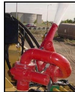
Es una vía de agua metálica que mueve un chorro de agua en sentido vertical (hacia arriba y hacia abajo) y lo hace girar (de derecha a izquierda). Los motores eléctricos de 24 V CC mueven la vía de agua en
