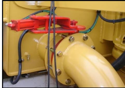
Para vaciar el agua del tanque se utiliza un BFV hidráulico fijado a la tubería de presión del tanque de agua. El BFV se controla eléctricamente desde la caja de control de la cabina y se activa por medio de un accionador hidráulico. Los accionadores reciben presión hidráulica del conjunto de caja de control de solenoides. Los desagües del tanque se alimentan por gravedad o presión.
