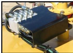
El conjunto posee tres electroválvulas hidráulicas que conducen la presión hidráulica hacia los motores hidráulicos del sistema lanza agua y el cilindro del BFV, según lo indique la caja de control de la cabina. El bloque de colectores tiene incorporada una válvula de alivio de presión que protege el sistema lanza agua contra condiciones de presurización excesiva. El conjunto está montado en la brida inferior del tanque y recibe presión hidráulica de la bomba hidráulica del vehículo.
