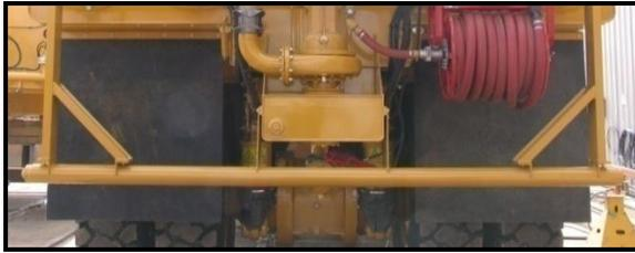
Es una barra rociadora que contiene varias hileras de orificios de drenaje de 3/8" que surten el agua. Un BFV de accionamiento hidráulico regula el suministro de agua que llega a la barra de descarga. El BFV se controla eléctricamente desde la caja de control de la cabina y se activa por medio de un cilindro hidráulico. Los accionadores reciben presión hidráulica del conjunto de caja de control de solenoides. Las barras de descarga se alimentan por gravedad o presión.
