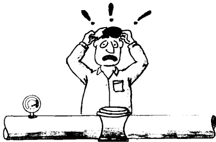
Figura 4.3 Las subpresiones y sobrepresiones ocasionan daños dentro de los medidores.
