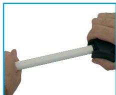
**1.** Cortar el tubo de forma perpendicular. Para tubos de 16 a 25 mm utilizar la tijera, para tubos de 32 hasta 63 mm utilizar el cortatubos.
