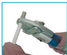
**3.** Durante el proceso de unión, no meter nunca la mano en la zona de compresión de la herramienta. Colocar la herramienta de compresión en ángulo recto. Comprobar que la mordaza está limpia y sin daños, con ello se puede garantizar una unión correcta.
