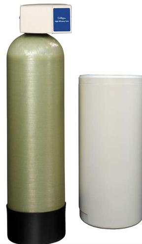
El descalcificador HE Culligan, estudiado para satisfacer una amplia gama de exigencias profesionales y semi-industriales, es un equipo específico para reducir la dureza del agua (cal y magnesio), mediante resinas de intercambio iónico seleccionadas e idóneas al contacto con agua para uso alimentario como, por ejemplo, las resinas de tipo Cullerx catiónicas fuertes en ciclo sódico que normalmente se regeneran con sal marina.
