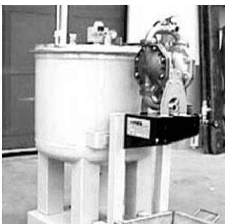
En la figura aparece representado un típico ejemplo de instalación para una bomba de membrana LARIUS.
