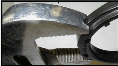
3. Ajuste la fijación con pinzas sujetadoras de canal modificado (K) para que la presión de los dientes no mueva la fijación.
