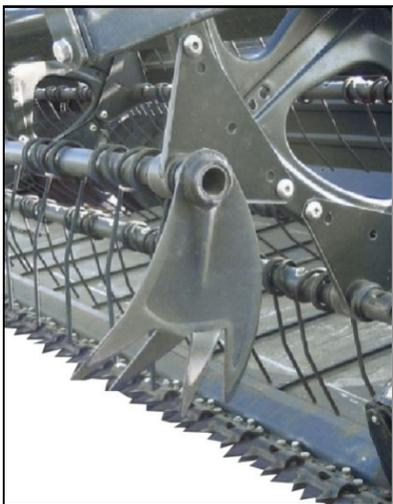
Los dientes de acero van acoplados a los extremos de uno de cada dos barras de púas y ayudan a transportar el material en cultivos tupidos y difíciles de cortar.
