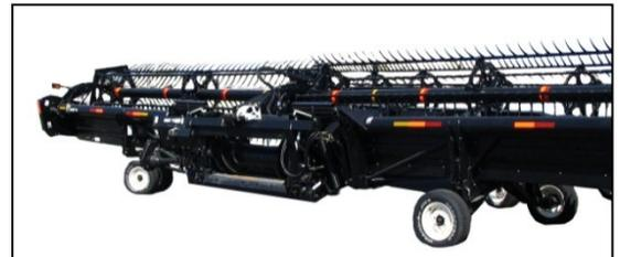
Disponibles como acople. Las ruedas estabilizadoras/auto-tráiler ayudan a estabilizar el plataforma en condiciones de campo que, caso contrario, harían que la plataforma rebote produciendo, como resultado, una altura de corte irregular.
