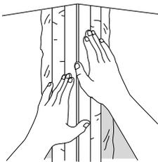
3.- Coloque sobre el vértice el esquinero presionando para fijarlo en su lugar. Debe quedar a tope con el plafón. Se embebe con el compuesto para juntas marca Redimix® corriendo la espátula a lo largo de ambos flancos en un ángulo de 45°.
