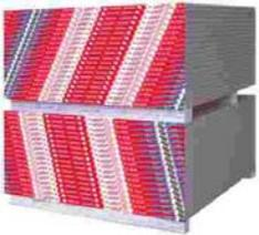
Fabricados en 15.9 mm (5/8") de espesor, combinan todas las ventajas de los tableros normales con una resistencia adicional a la exposición del fuego. Peso: 12.46 kg/m<sup>2</sup>
