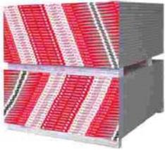
Fabricados en 9.6 y 12.7 mm (5/8" y 1/2") de espesor respectivamente, cuentan con bordes longitudinales rebajados en la cara aparente para formar una leve depresión y reforzar las juntas. Peso: 6.75 y 7.98 kg/m<sup>2</sup>.
