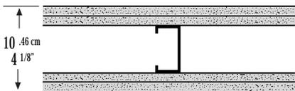
Postes metálicos - dos capas de tablero de yeso marca Tablaroca® / Sheetrock® Firecode® de 15.9 mm (5/8"), en cada lado - postes 410 (15/8") @ 61cm. - capa base atornillada - capa aparente laminada o atornillada - juntas alternadas y tratadas o sin acabar - perímetro calafateado - DISEÑO UL U411 ó U419
