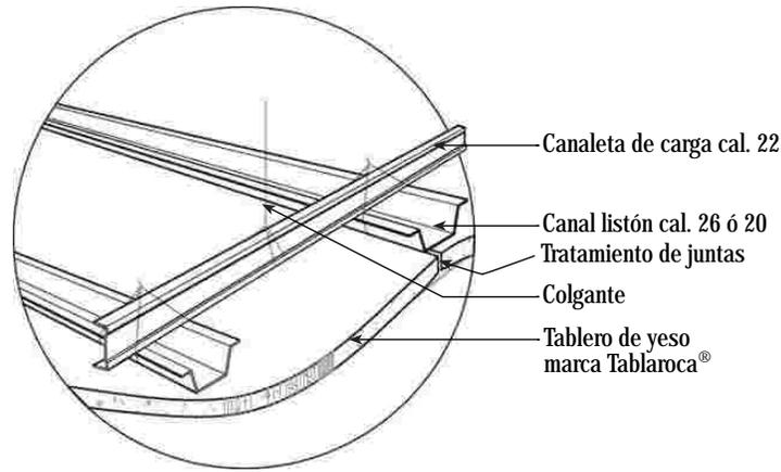
El tablero de yeso de 9.6 mm de espesor no es recomendable para la aplicación de plafón corrido, los espesores recomendados son de 12.7 y 15.9 mm en sus diferentes versiones Firecode, Firecode C o regular. Para el tipo WR los canales listón deberán espaciarse máximo a cada 30.5 cm debido a que el tablero es más flexible.
