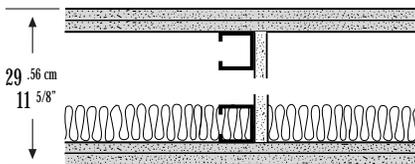
Postes metálicos - dos capas de tablero de yeso marca Tablaroca® / Sheetrock® Firecode® de 15.9 mm (5/8"), en cada lado - postes 410 (15/8") @ 61cm en dos filas separadas entre sí 15 cm - capa base atornillada - capa aparente laminada o atornillada - juntas alternadas y tratadas o sin acabar - perímetro calafateado - DISEÑO UL U420
