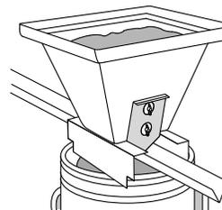
6.- El esquinero metálico revestido con papel para tableros de yeso se aplica rápidamente, utilizando compuesto para juntas al reborde con una tolva de instalación. Luego se presiona el reborde contra la esquina.
