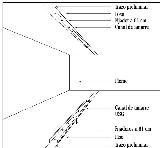
b) Los postes metálicos USG se introducen dentro de las canales y se hacen girar hasta quedar perfectamente ajustados. La separación normal es de 61.0 cm aunque se pueden colocar, por diseño, a cada 40.6 cm o a cada 30.5 cm.
