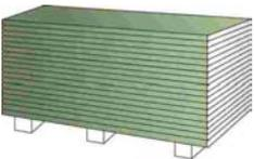
Se compone de un núcleo especial de yeso con resistencia al fuego y humedad, formado con varias capas de papel verde tratado para resistir la penetración de la humedad. Se usa en los muros divisorios para ductos de elevadores y en los sistemas de control de sonido de alto rendimiento. Estos tableros tienen orillas biseladas y dimensiones de: 2.5 cm (1") de espesor, 61 cm (24") de ancho y largos sobre pedido. Peso: 18.19 kg/m<sup>2</sup>
