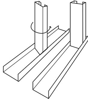
No es necesario asegurar mecánicamente la unión del canal y poste exceptuando en los siguientes casos:
