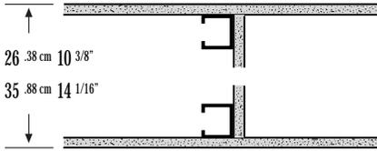
Muro formado a base de un doble bastidor con postes metálicos - tablero de yeso marca Tablaroca® / Sheetrock® Firecode® C tipo X, de 15.9 mm (5/8"), a cada lado - postes 4.10 (1-5/8"), @ 61cm, en dos filas separada entre sí 15 cm, refuerzos con segmentos de tablero de yeso de 15.9 mm (5/8") o canales de amarre metálicos atornillados a los postes @ 1.22- tableros colocados y atornillados en forma vertical - juntas alternadas y tratadas- DISEÑO UL U420
