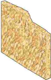
Sound Attenuation Fire Blankets (SAFB), son colchonetas semi-rígidas, sin papel, diseñadas para mejorar las clasificaciones STC al instalarse en ensambles con postes metálicos o de madera. La densidad nominal es de 2.5 kg/m<sup>3</sup> y están disponibles en 61 ó 40.6 cm, en 1.22 m de largo y espesores de 2.5 a 7.5 cm.
