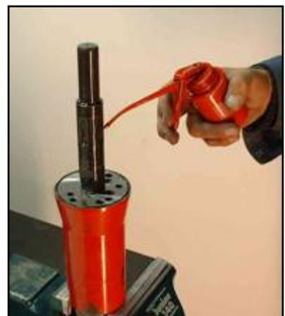
Antes de montar el bloque de válvula, retire el exceso de aceite y de cobertura protectora de puesta en marcha de la superficie del cilindro.
