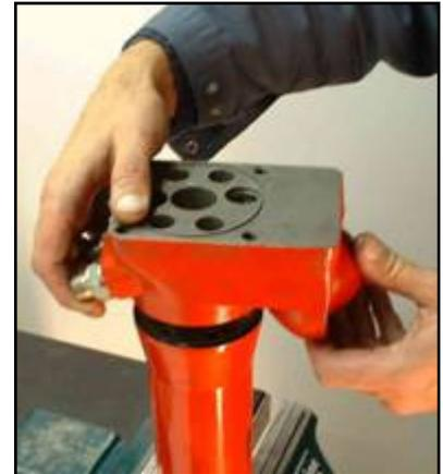
Gotee con Loctite 243 los tornillos y ajústelos en cruz en tres etapas, según lo especificado en el esquema a continuación.
