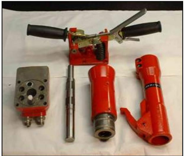
Antes de montar el pistón de percusión, controle minuciosamente la superficie del pistón y de la parte interna del cilindro. Las marcas de desgaste son aceptables pero no debe haber rayas que se puedan notar con la uña.
