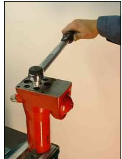
Monte el mango, gotee con Loctite 243 los tornillos y ajuste a 70 Nm.
