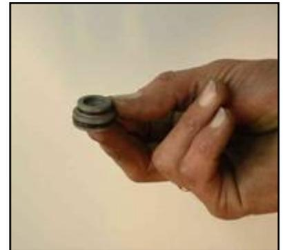
Si el martillo tiene una pérdida de aceite en el vástago activador, se deberán cambiar las guarniciones en la empaquetadura.
