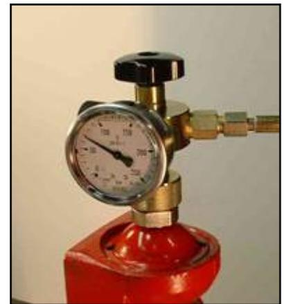
Abra lentamente la válvula de la llenadora (foto A) y ciérrala nuevamente cuando el manómetro indique 50 bar.
