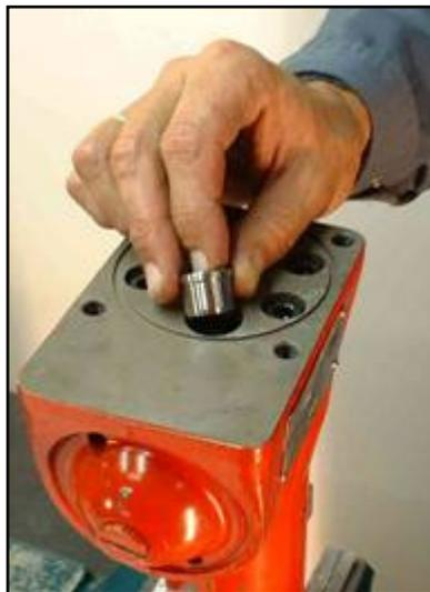
Monte los resortes en el orificio del activador, y luego monte la válvula activadora completa.
