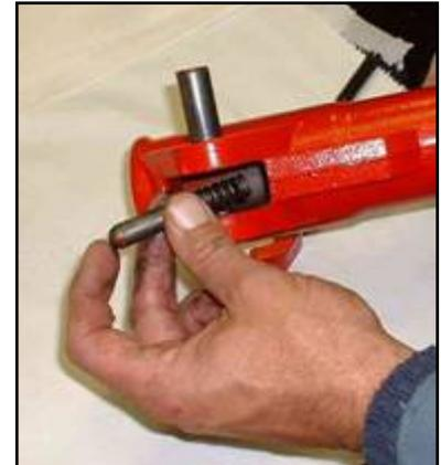
Controle que el fijador del cincel y el pasador no tengan marcas de desgastamiento, y cámbielos si es necesario.
