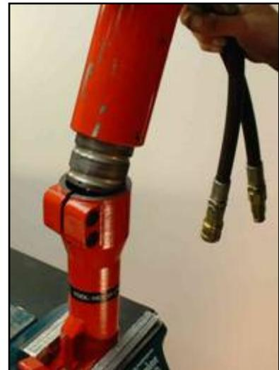
Desmonte el bloque de válvula, y retire el pistón de percusión.
