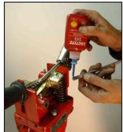
Ajuste los tornillos de la parte inferior del martillo a 40 Nm. Si se ajustaran en exceso, causarían una deformación del cilindro, y así el atascamiento del pistón de percusión.
