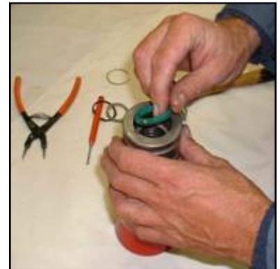
En todas las reparaciones se deberá cambiar el sellado en el fondo del cilindro.
