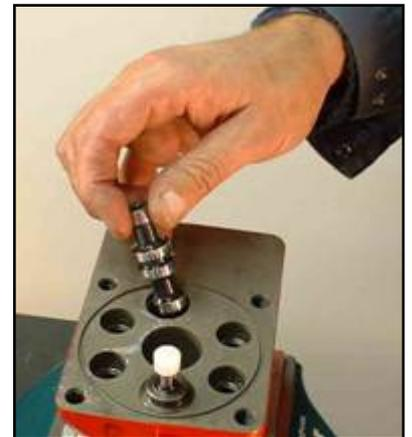
Desmonte la válvula de retención y controle si está desgastada.
