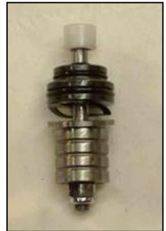
Cuando se repare la válvula activadora, es importante evitar aflojar el pistón del vástago del pistón. Estas piezas han sido adaptadas la una a la otra y se entregan como una sola pieza de repuesto.
