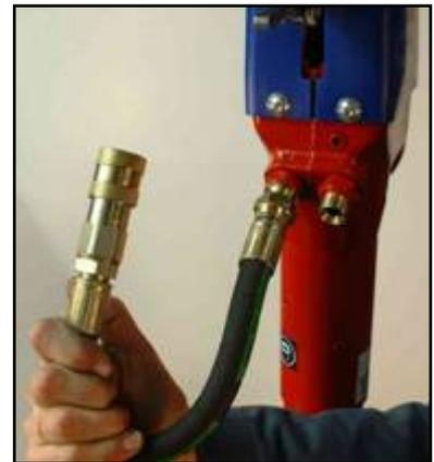
La manguera de retorno con acoplamiento macho de acción rápida se monta donde está marcado con una T.
