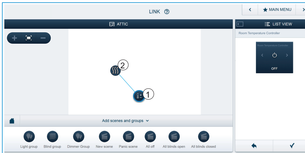
Fig. 10: Conectar un termostato a un actuador
