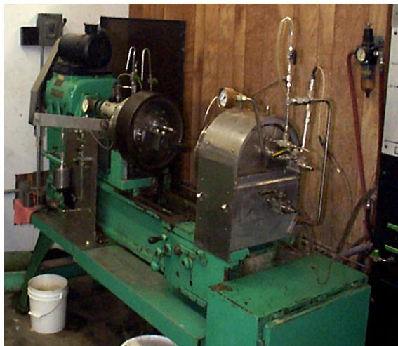
Figura 1 Probador de lubricidad de HLT de Westport/MI Drilling Fluids
