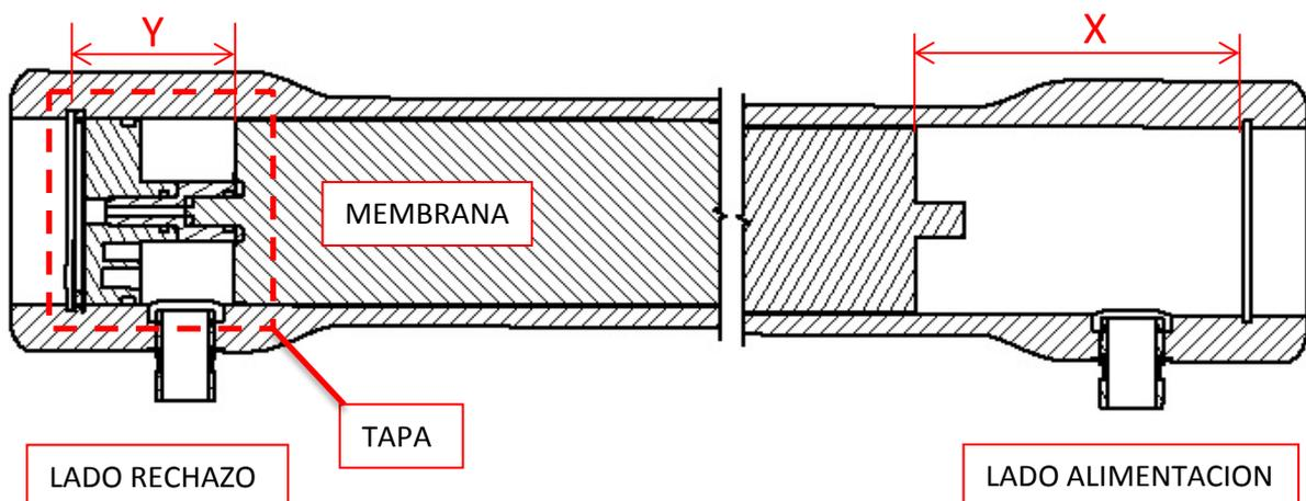
**ADVERTENCIA:** Únicamente se colocarán discos espaciadores en el lado de la tapa del lado de alimentación al tubo de presión
