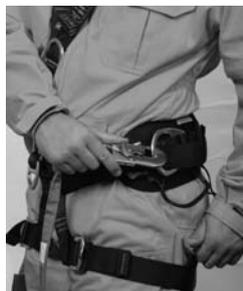
Después de instalar el maillón rápido, pase el estrobo con el protector de goma por la estructura deseada y conecte el gancho en la otra extremidad del arnés.
