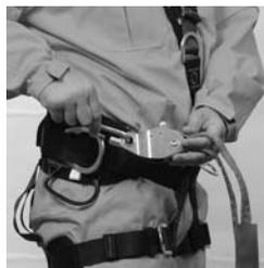
Conecte y cierre el conector en la argolla lateral del arnés.
