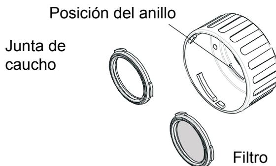
*La junta de caucho o el filtro se sujeta por tres anillos que se encajan en la cubierta. Separe cuidadosamente la junta de caucho o el filtro de los puntos de ubicación de los anillos en la cubierta o accesorio.*
