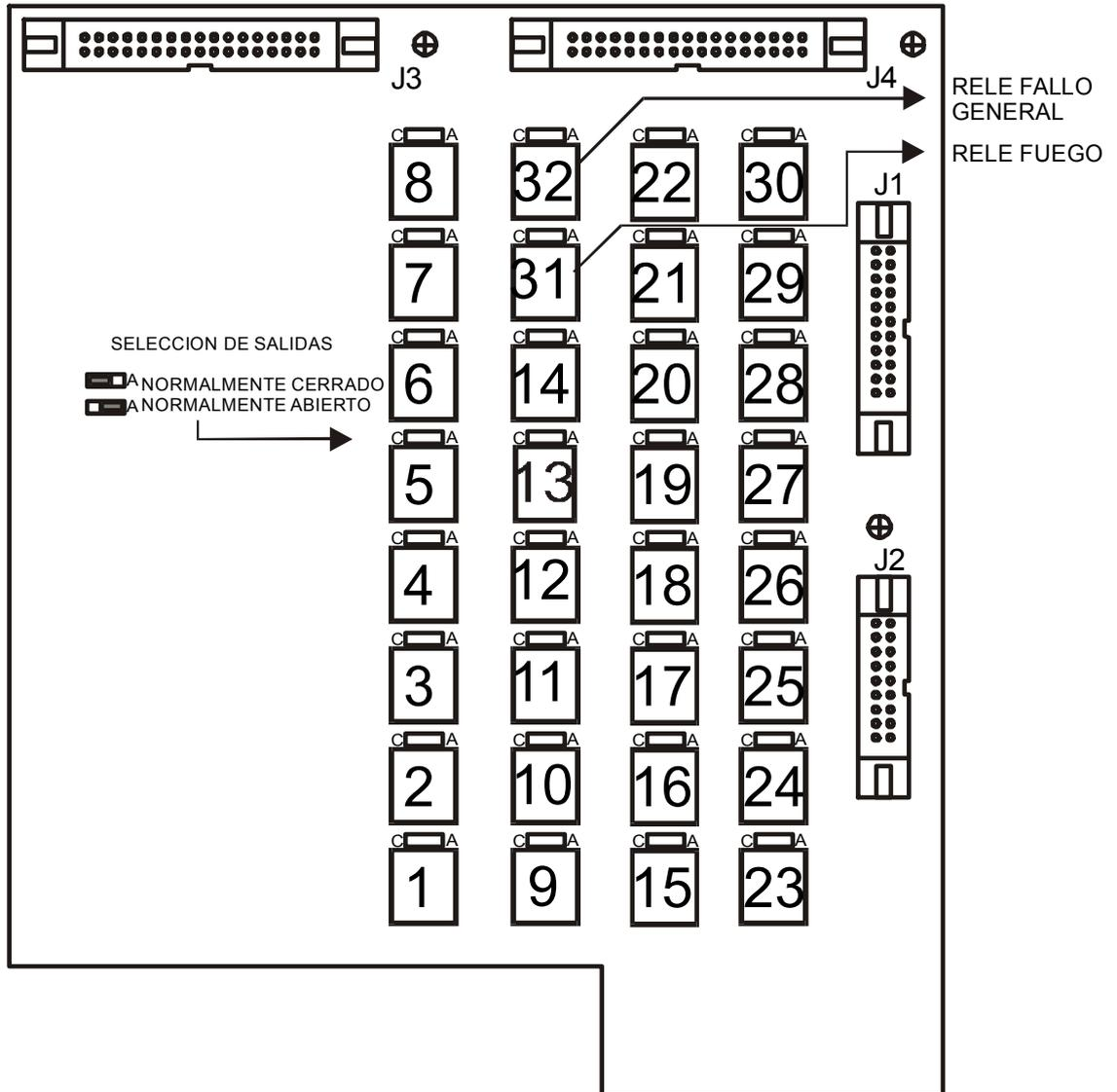
Fig.: 7 Tarjeta de transmisión de alarmas.
