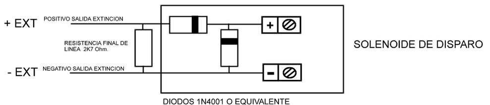
Fig.: 3 Conexión de la electroválvula de disparo.
