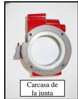
7. Retire el cojinete de poliuretano de la carcasa de la junta e inspeccione la carcasa para detectar cualquier fisura, indicio de corrosión o daño.
