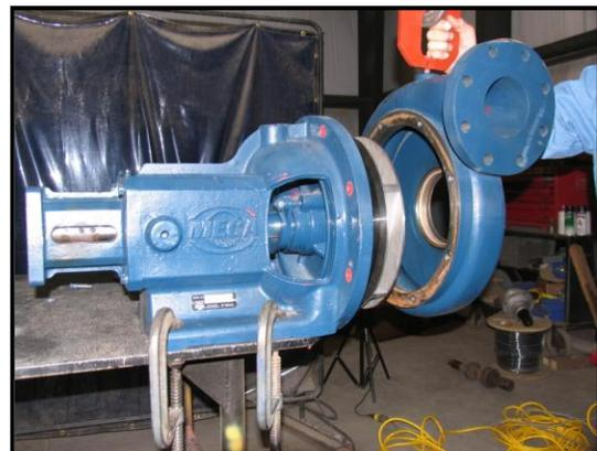
2. Inspeccione la caja tipo voluta para controlar:
