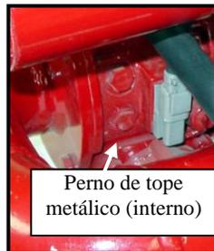
4. Extraiga los pernos de montaje de la junta, como se indica a continuación.
