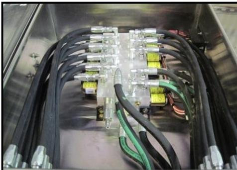
Típica caja de control hidráulico montada en el tabique delantero
