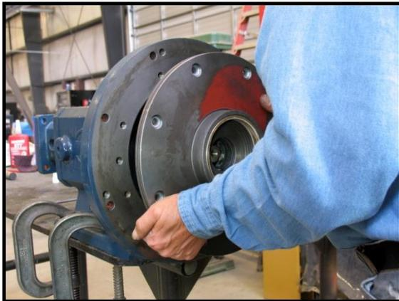
9. Coloque 8 pernos de montaje y suplementos de plástico.
