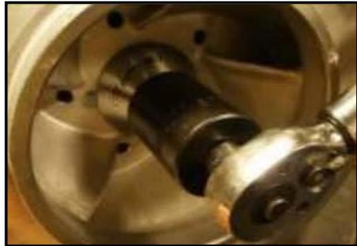
15. Ajuste la tuerca giratoria del impelente hasta alcanzar un par de apriete de 234 libras pie (318 nm).
