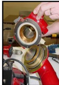
6. Extraiga los pernos de montaje que se encuentran en la parte inferior de la junta y retire el conjunto de engranaje de tornillo sin fin y la vía de agua.
