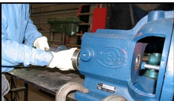
4. Instale el montaje del motor de mando con sello para grasa (borde EXTERNO) y ajuste los pernos de montaje hasta alcanzar un par de apriete de 20 pies libra (28 nm).
