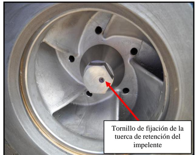
2. Inspeccione el impelente para controlar:
