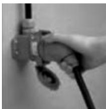
Para conectar una toma PN, encarar la base con la clavija (indicado por 2 puntos rojos). Introducir ligeramente la clavija, después girar a la izquierda hasta que el equipo quede enclavado. Su grado de estanqueidad es ahora IP67.
