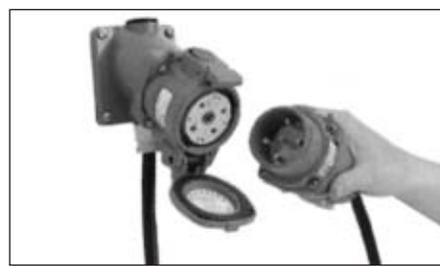
La clavija y la base están separadas: todas las partes activas están protegidas contra el hilo tan delgado como de 1 mm de diámetro (IP4X) para los modelos DB, DS y DSN gracias a su disco de seguridad.
