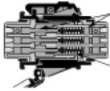
**1** Cuando la clavija y el receptáculo están conectados, la cámara de arco a prueba de explosiones se completa con conductos para liberación de presión o extinción de arco entre el diámetro exterior del contacto de la clavija y su orificio de contacto correspondiente en el apagador de seguridad, y entre el compartimiento principal interior y la base del contacto del receptáculo.
