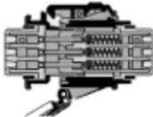
**2** Los DXN son dispositivos de interrupción de corriente. Pueden abrirse y cerrarse con seguridad y cortarse en cargas completas y también durante situaciones de sobrecarga moderadas. Durante la apertura y cierre de contactos, la cámara de arco contiene por completo cualquier ignición de gas o polvo causada por el arqueo y los conductos a prueba de explosiones disipan la presión.
