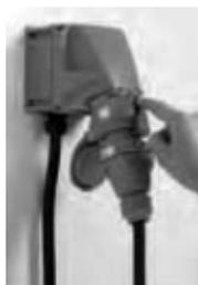
Una simple presión sobre el trinquete de enclavamiento situado en la parte superior de la base, permite la separación de los contactos de la base de los de la clavija, quedando ésta sin tensión en la base al retroceder hasta su posición de reposo.
