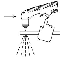
Para realizar un corte por arrastre apoye el tubo de contacto directamente sobre la pieza; para obtener la máxima velocidad de corte y una mayor vida útil del tubo de contacto mantenga una separación vertical de entre 1/16 y 1/8 de pulgada (1,6 y 3,2 mm) (el corte por arrastre reduce la vida del tubo de contacto).
