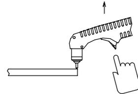
Ajuste la velocidad de la antorcha de manera que las chispas pasen a través del metal y salgan por la parte de abajo del corte.
