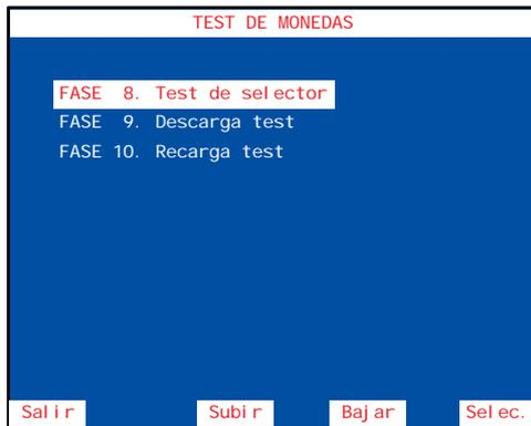
El menú **TEST DE MONEDAS** permite acceder a diferentes fases cuya finalidad es verificar el funcionamiento de los componentes del circuito de monedas: selector, desviador, descargadores y canales.
