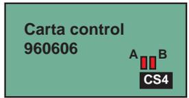
La máquina dispone de un sistema de configuración compuesto por dos grupos de 8 microinterruptores cada uno, situados en la carta control
