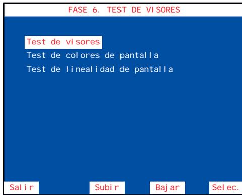
El menú **TEST DE VISORES** permite acceder a tres fases cuya finalidad es comprobar los visores display de siete segmentos y facilitar el mantenimiento de los circuitos de video.
