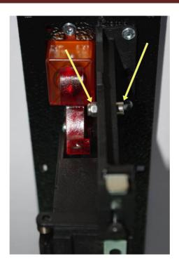
3. Introducir las dos bridas, adosar la bobina a tope frontal, con el cable hacia delante ( y hacia arriba) a la canal de entrada de monedas tal como indica la imagen y fijarla firmemente mediante las dos bridas
