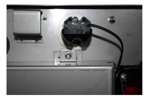
Sustituya el controlador de la caja por el nuevo (recuerde que debe configurar el controlador), proceda a conectar el cable de la boquilla al conector ubicado en la parte inferior del controlador y la instalación habrá finalizado.
