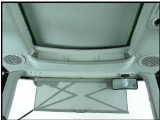
Las nuevas cortinillas parasol John Deere mejoran el confort del operario en los días soleados bloqueando directamente la luz y reduciendo los deslumbramientos. Además, eliminan el calor generado en la cabina. Debido a un ajuste vertical independiente, se pueden subir y bajar a la posición deseada hasta que el conductor consiga el máximo confort. Los conjuntos se pueden montar en la ventana delantera o trasera e incluyen todas las piezas necesarias para montaje en campo de manera sencilla.
