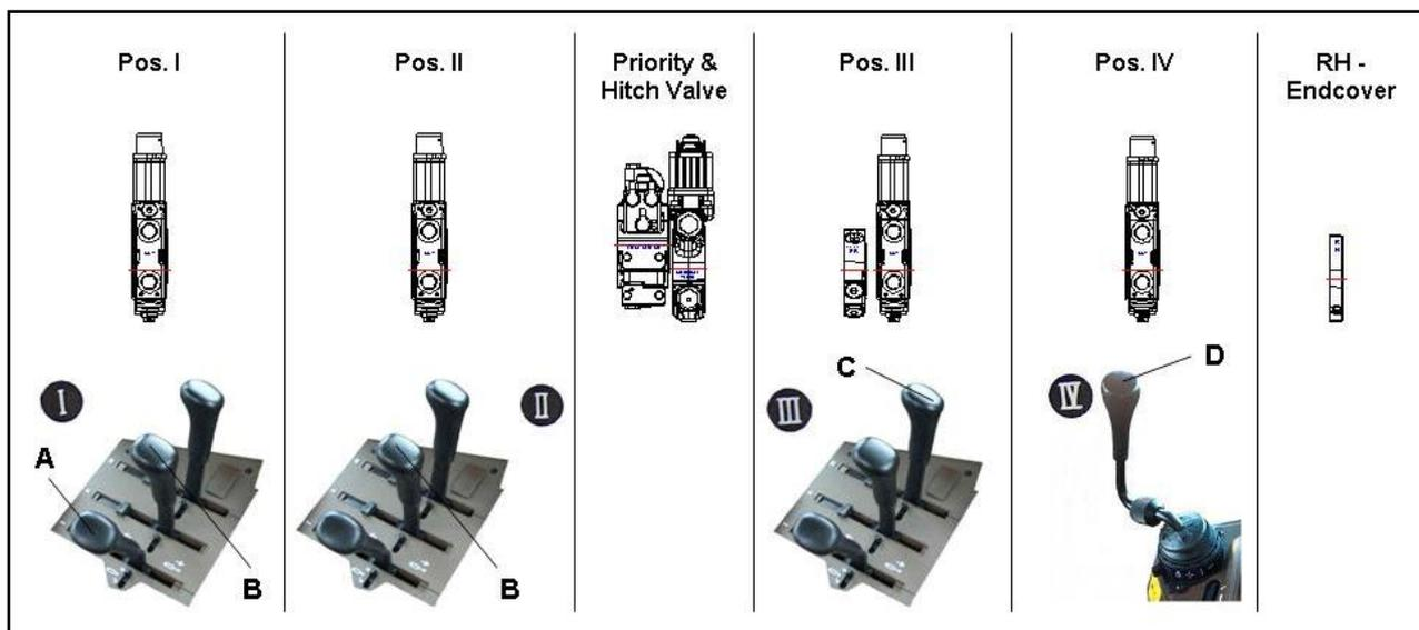
Los conjuntos de modificación M-SCV contienen también los enchufes estándar y las cajas de protección antipolvo. Los componentes de accionamiento y accesorios, enumerados en la columna "nota" de cada conjunto M-SCV, deben pedirse por separado dependiendo de la posición en la que se instale la VMD.
