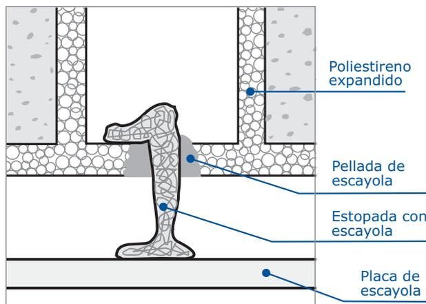
Detalle de instalación de falso techo de escayola
