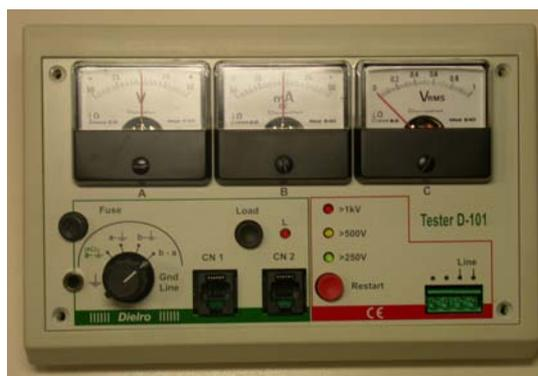
El **Tester D-101** es el equipo de medida que permite chequear una línea telefónica analógica PSTN o PTN así como la calidad de la toma de tierra del edificio, si existe, antes de conectar los equipos **Dielro**.
