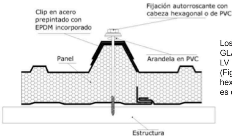
Los paneles GLAMET® A42-P1000-G4, GLAMET® FRIGO, GLAMET® CLEAN, GLAMET® Cal. 26/Inox y GLAMET® LV instalados en pared prevén el siguiente grupo de fijación (Fig.2b): Tornillo autorroscante/autoperforante con cabeza hexagonal o PVC y arandela PVC. La longitud de la fijación es en función del espesor del panel.
