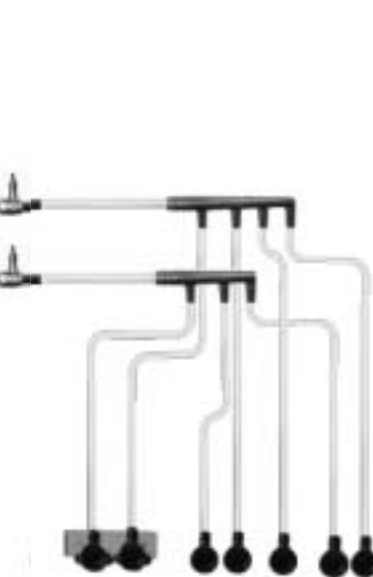
INSTALACIÓN POR COLECTORES
