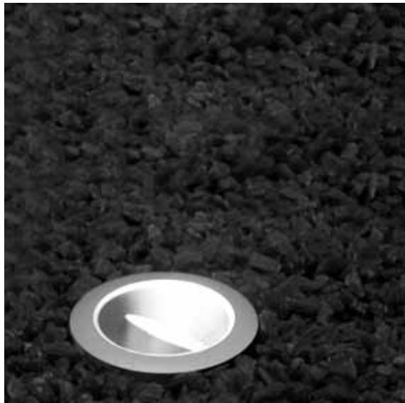
cuerpo iluminante-proyector empotrado para interiores y exteriores IP67 IK07 (2 joule), formado por un cuerpo cilíndrico de aluminio opaco o negro opaco y un embellecedor redondo o cuadrado de aluminio plateado brillante. m44 lleva portalámparas GU5,3 para lámparas dicroicas, diámetro 51 máx 35W o portalámparas GX10 para lámparas 35W o cableado con led 8W 3000K. puede montarse empotrado, mediante arquetas, en el suelo o en la pared.
