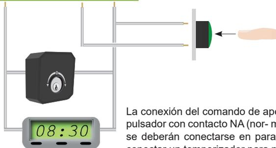
La conexión de la orden de apertura start se pueden hacer con cualquier pulsador con el tipo de contacto NA (Normalmente Abierto).
