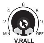
Velocidad de ralentización. Activación de velocidad de ralentización y de activación de la ralentización (MINIMA-OFF). Para la mayor hoja de los motores el nivel mínimo es 4. Se debe plantear una velocidad de 1/3 de la velocidad normal del motor. Para desactivar la ralentización necesita que girar el trimmer su OFF.
