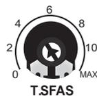
Tiempo del desfase de la puerta cuando abre y cuando cierra, la abertura parte de un mínimo de un segundo y si está ajustada al máximo nivel, la ventana nº 2 abre cuando la ventana 1 a terminado el tiempo de trabajo.
