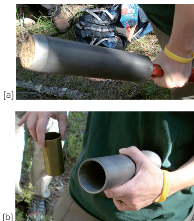
Figura 32. a) Barreno de golpe, y b) cilindro volumétrico calibrado. Fotos: Diego Navarrete.
