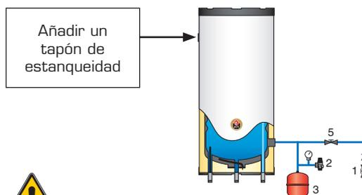
Si el acumulador primario no se llena y purgado, no encender la resistencia eléctrica del acumulador.
