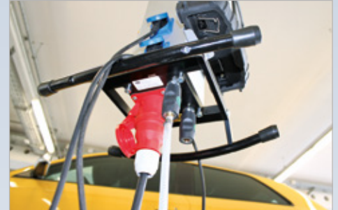
Manejo sencillo de los acoplamientos de aire comprimido inferiores ( acoplamientos de aire comprimido de seguridad ISO 4414 EN 983 ) y alimentación de energía (400 V).
