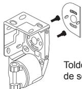
Toldo de brazos invisibles instalado con un sistema lateral de soportes que permiten una fijación extrafuerte.
