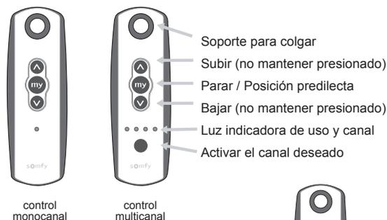
**PASO 4.** Presione el botón programación en el control remoto (se encuentra en la parte posterior del mismo), hasta que el producto motorizado haga un breve movimiento en ambos sentidos [ ciclo ], o 3 segundos (en caso de tener un receptor CENTRALIS, EOLIS o SOLIRIS).
