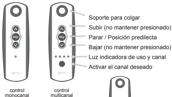
Presione el botón de programación del control remoto hasta que el led en el interior del receptor EOLIS parpadee.
