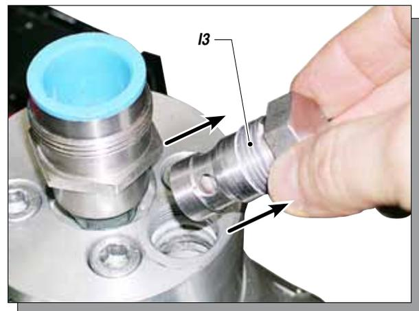
Tras la limpieza, agite la válvula (13) con las manos para verificar que la esfera interna se mueva sin trabas en su alojamiento; si fuera necesario, vuelva a limpiar la válvula.
