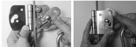
3 Posicione el salva caída abierto atrás del cable de acero, con la indicación de la flecha hacia arriba, encajando el cable entre el alojamiento y el bloqueador. Cierre el salva caída.
