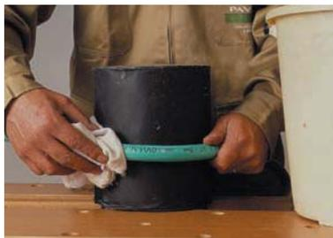
Es aconsejable tensionar el tubo a medida que se dobla para evitar arrugas en la parte interior de la curva. Tan pronto la curva esté formada debe enfriarse con un trapo mojado en agua fría.
