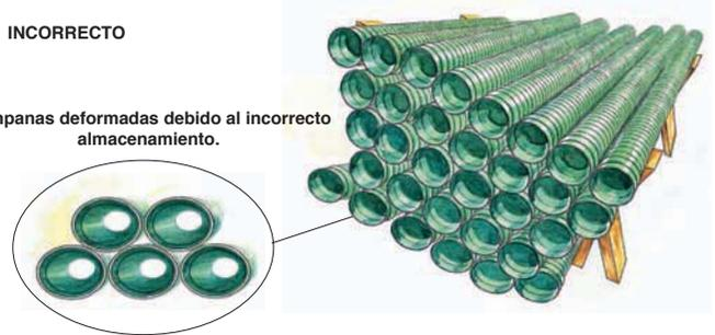
Cuando el almacenamiento de las Tuberías se hace al aire libre deben protegerse de los rayos del sol, colocándolas bajo una cubierta que no permita el paso de la luz directa, que tenga suficiente ventilación y apilándolas siempre a una altura que no pase de 1.50 mts.
